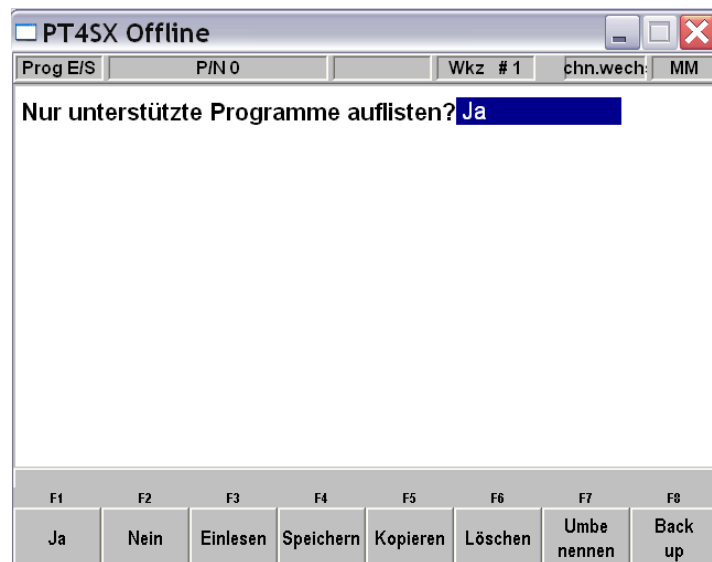
ABBILDUNG 13.0 Unterstützte Programme sind Teileprogramme, die auf der ProtoTRAK SLX CNC laufen können. Sie müssen diese Frage nicht jedes Mal beantworten, wenn Sie in diesem Bildschirm sind. Betätigen Sie einfach den Softkey für die gewünschte Funktion.
